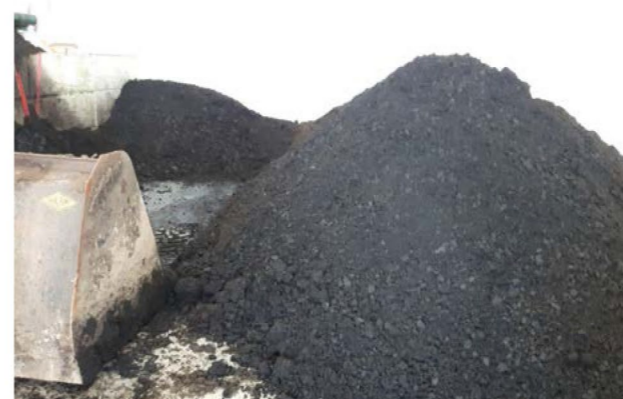
Odvodněná pevná hmota má obsah sušiny přibližně 30 % a slouží jako hnojivo s vysokým obsahem živin, které se snadno přepravuje.
