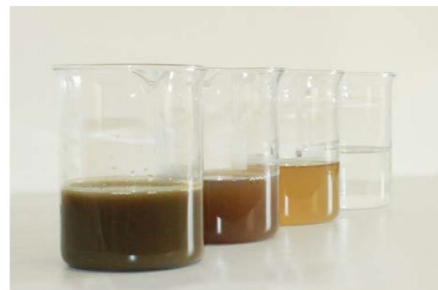
Pevné látky z kejdy se oddělují od vody ve čtyřech krocích. Výsledkem je: Voda, koncentrát živin a suché hnojivo.
