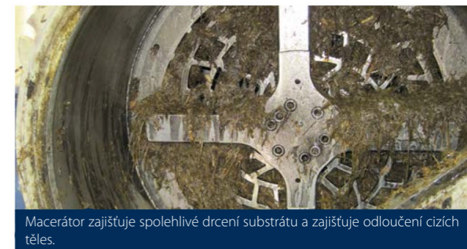
Rozmělnění pevných materiálů je prováděno již v prvním stupni.
